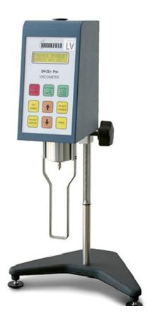
Fig: BROOKFEILD VISCOMETER
